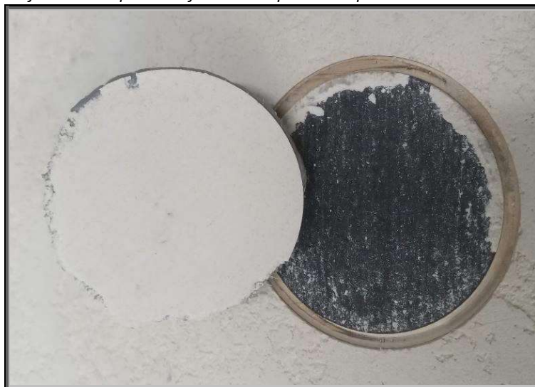
Figura 5 – Detalhe da forma de ruptura na face da chapa de compensado naval – Amostra 01557/2023-004
