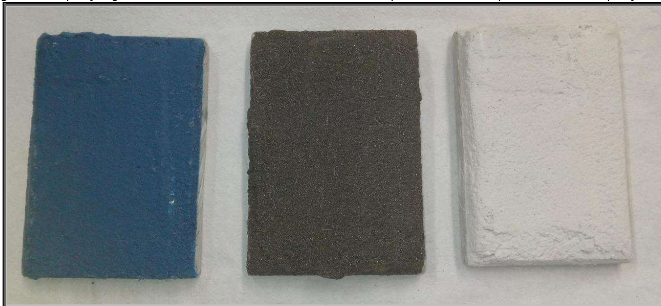
Figura 1 – Disposição geral das amostras revestidas antes do teste de impermeabilidade – Após 670 horas de exposição UVA
