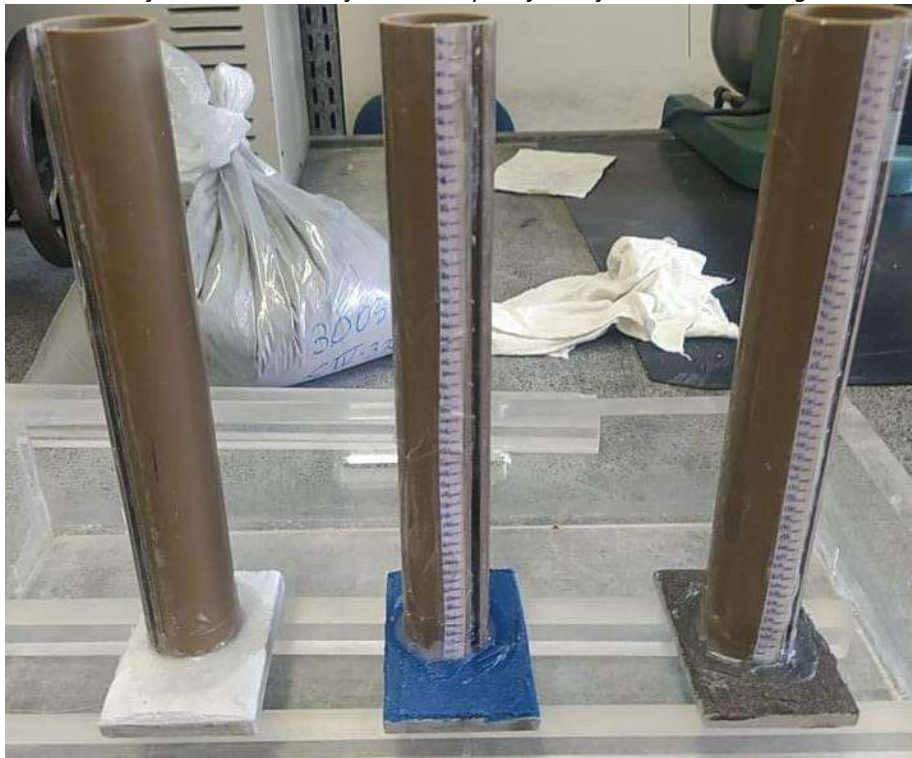
Figura 3 – Instalação de tubos de seção circular para formação de coluna de água de 250 mm
