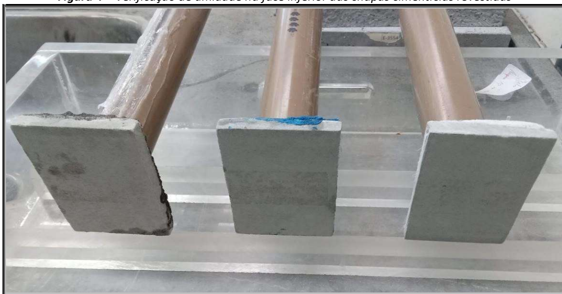
Figura 4 – Verificação de umidade na face inferior das chapas cimentícias revestidas
