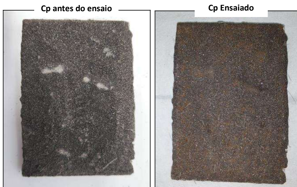
Figura 11: Imagens do corpo de prova (cp) da amostra 3 antes (esquerda) e após 2000 horas de ensaio (direita).
