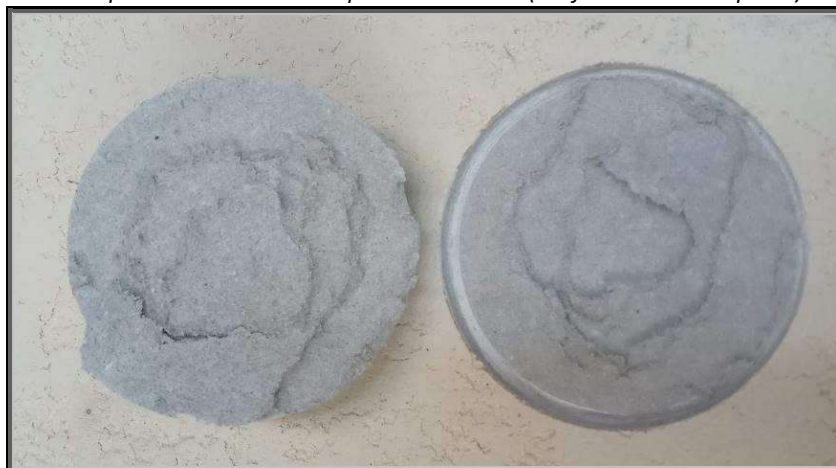
Figura 4 – Detalhe da forma de ruptura no substrato de placa cimentícia (desfolhamento da placa) – Amostra 01557/2023-003
